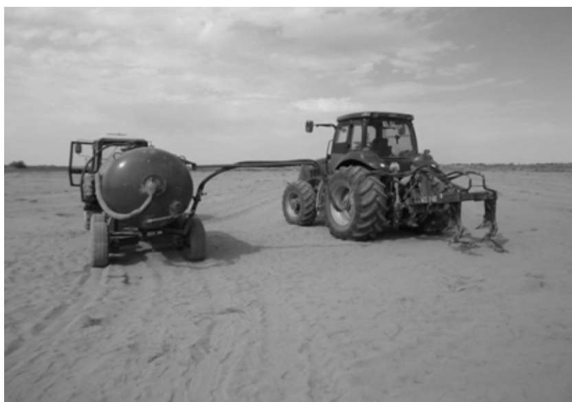
Рис. 2. Общий вид универсальной агромелиоративной машины НАД-2-60М в агрегате с трактором Case и ёмкость для внесения ЖОМУ в агрегате с трактором МТЗ-80Х в рабочем положении
