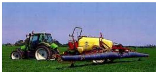
Рис. 2. Опрыскиватели с ветрозащитными устройствами активного действия
