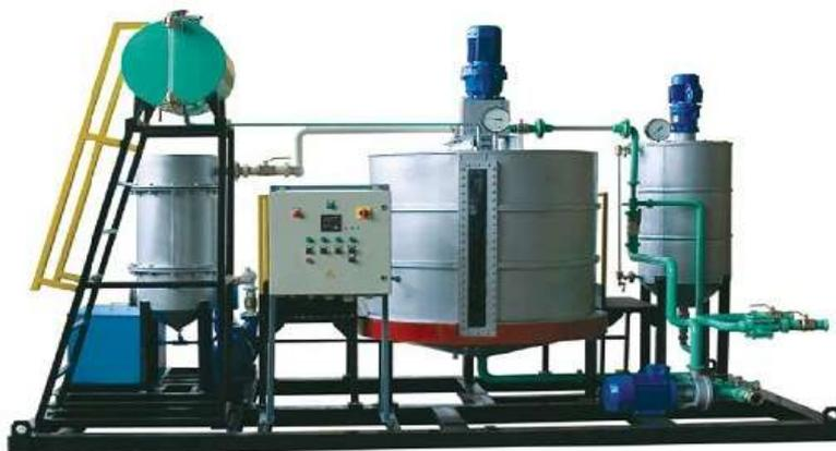
Рисунок 5 - Установка для производства биодизеля.
