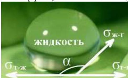
Рисунок 1 - Капля жидкости на супергидрофобной поверхности
