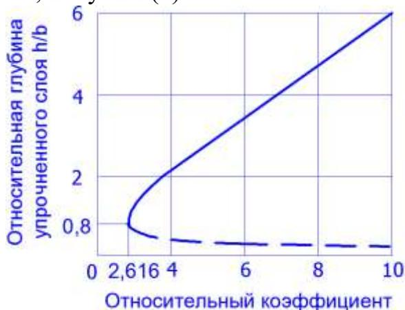
Рисунок 1 - График зависимости относительной глубины упрочненного слоя от относительного коэффициента
