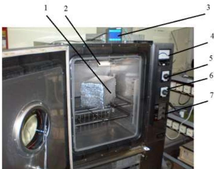
Рисунок 1- Внешний вид климат камеры ТАВАЛ с экспериментальным образцом: 1- объект хранения под тепловым экраном; 2- ртутная лампа; 3- индикаторное табло; 4- стрелочный термометр; 5- переключатель режимов нагрева; 6- переключатель режимов охлаждения; 7- пульт управления
