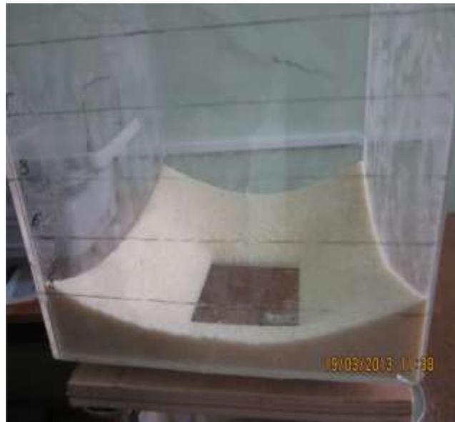
Рисунок 2 - Процесс истечения материала, угол откоса 40°
