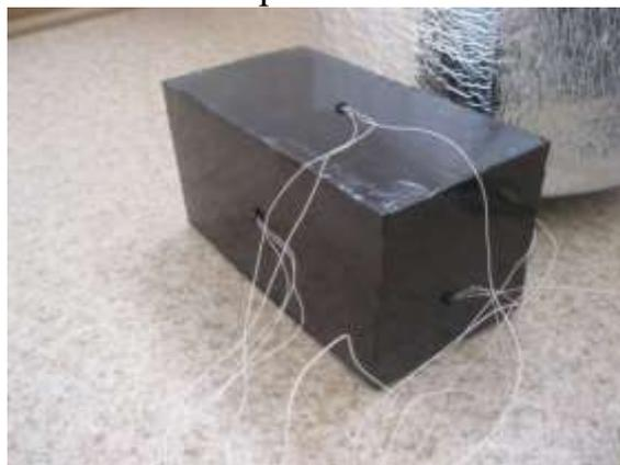
Рисунок 2 – Размещение термодатчиков на модели экспериментального образца
