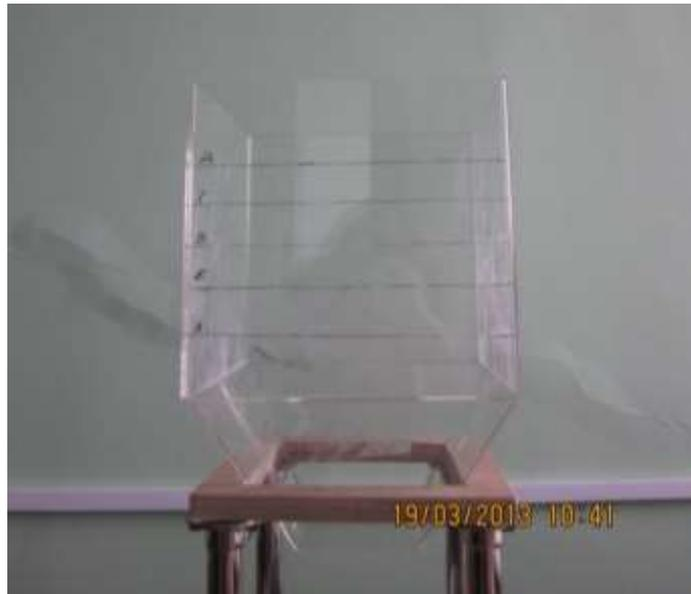
Рисунок 1 - Модель бункера с углом откоса в 25°
