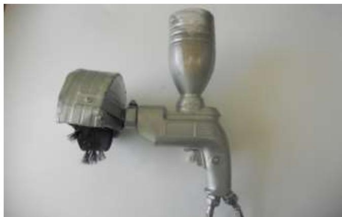
Рисунок 2 - Устройство для очистки стыковых и сварных соединений деталей с/х техники.
