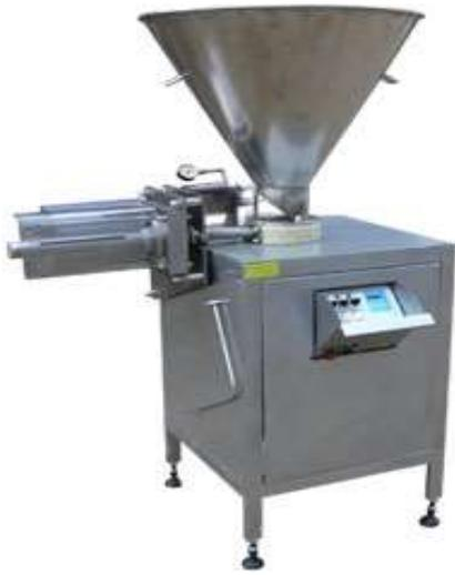
Рисунок 1 – Шприц-дозатор ИПКС-047П
