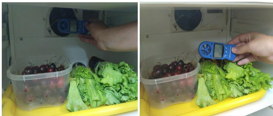
Рисунок 3 – Определение скорости холодного воздуха у подающего вентилятора и поверхности хранимого продукта посредством цифрового анемометра AR816+
