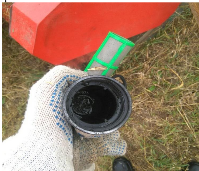
Рисунок 3 – Образование осадка в виде торфяной крошки в фильтрующем элементе
