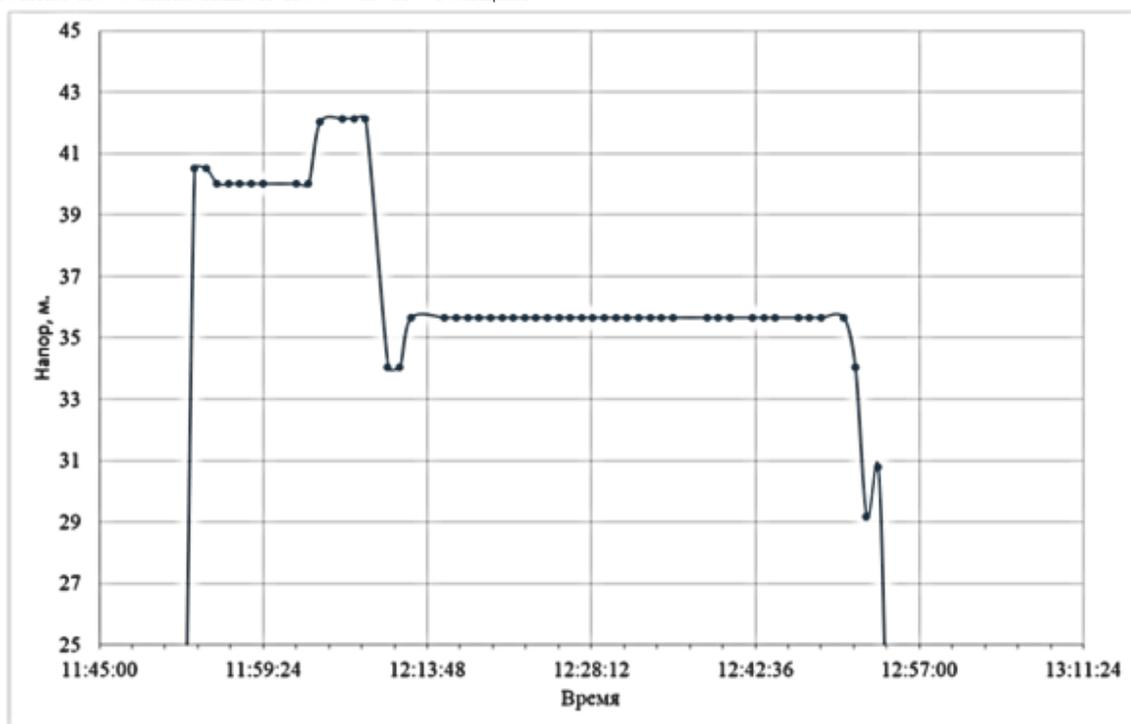
Рис. 2. График изменения давления на экспериментальной установке, показания манометра и датчика давления
