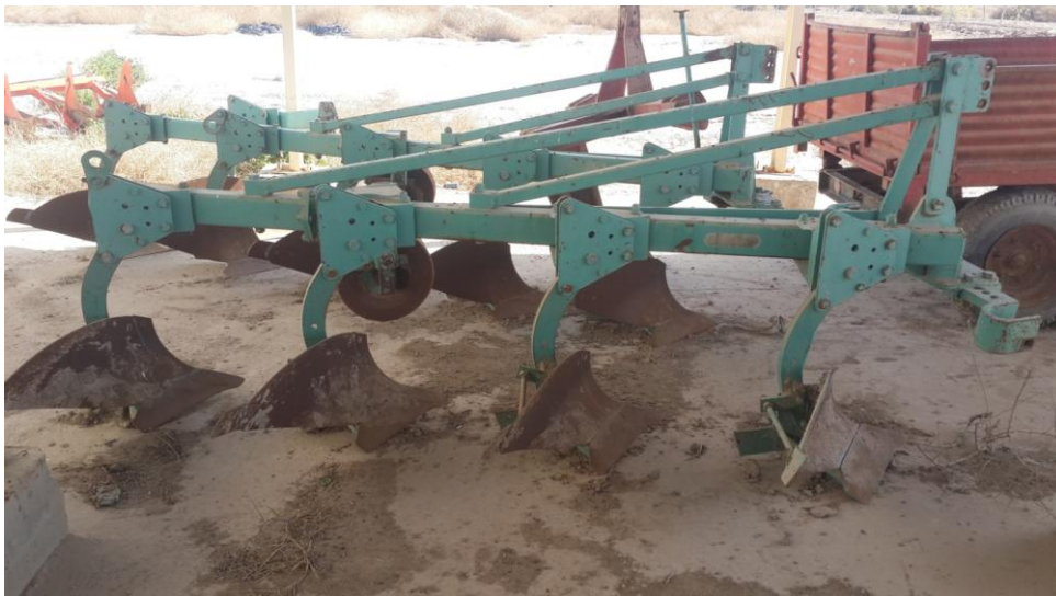
Рисунок 8 – Сельскохозяйственные машины для основной обработки почвы применяемые на предприятии. Плуг четырехкорпусной
