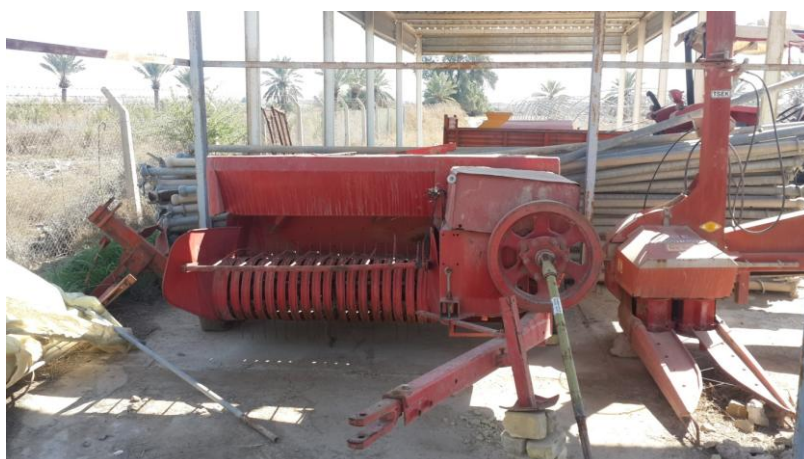
Рисунок 19 – Машины для уборки сельскохозяйственных культур. Слева: тюковой пресс-подборщик, справа: косилка для скашивания и измельчения кормовых культур
