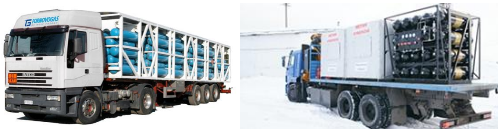
Рисунок 4 – Передвижные автомобильные газовые заправки (ПАГЗ)
