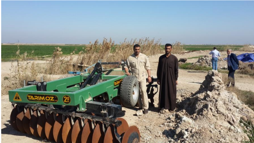
Рисунок 10 – Сельскохозяйственные машины для поверхностной обработки почвы применяемые на предприятии. Дисковая борона Tarimoz, пр-во Турция
