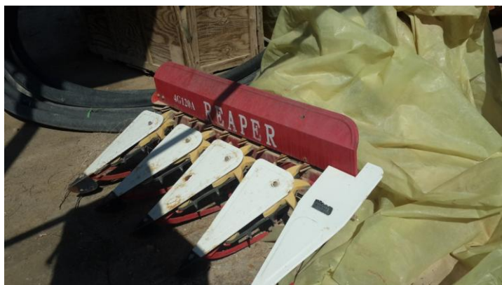
Рисунок 18 – Мини жатка для уборки риса и пшеницы на базе мотокультиватора Yancheng Xinmingyue Machinery Manufacture, пр-во Китай
