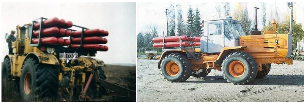
Рисунок 1 – Трактора К-700 и Т-150К, переоборудованные для работы на метане [2]
