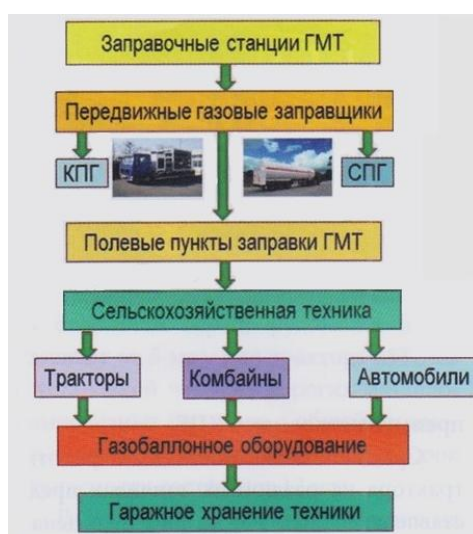
Рисунок 5 – Схема заправки ГМТ сельскохозяйственной техники
