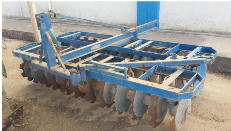
Рисунок 11 – Сельскохозяйственные машины для поверхностной обработки почвы применяемые на предприятии. Дисковая борона Nardi, пр-во Италия
