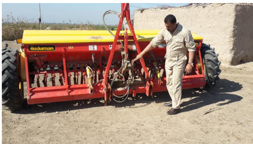
Рисунок 12 – Машины для посева и посадки сельскохозяйственных культур. Сеялка зернотуковая Zduman, пр-во Турция
