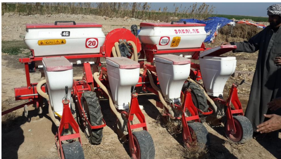
Рисунок 13 – Машины для посева и посадки сельскохозяйственных культур. Сеялка кукурузная четырехрядная Sakalak, пр-во Турция
