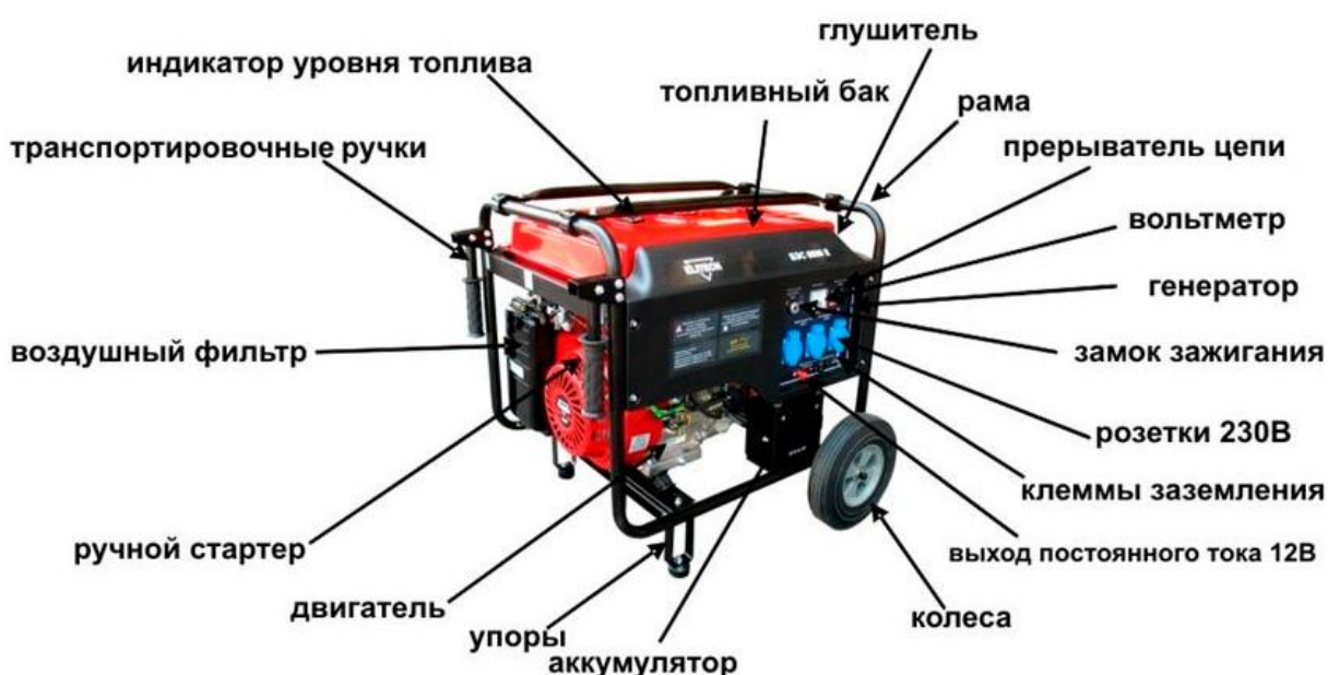
Рисунок 1 Устройство бензинового электрогенератора.
