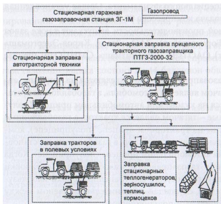
Рисунок 3 – Технологическая схема заправки природным газом техники с использованием газозаправщиков ЗГ-1М и ПТГЗ-2000-32
