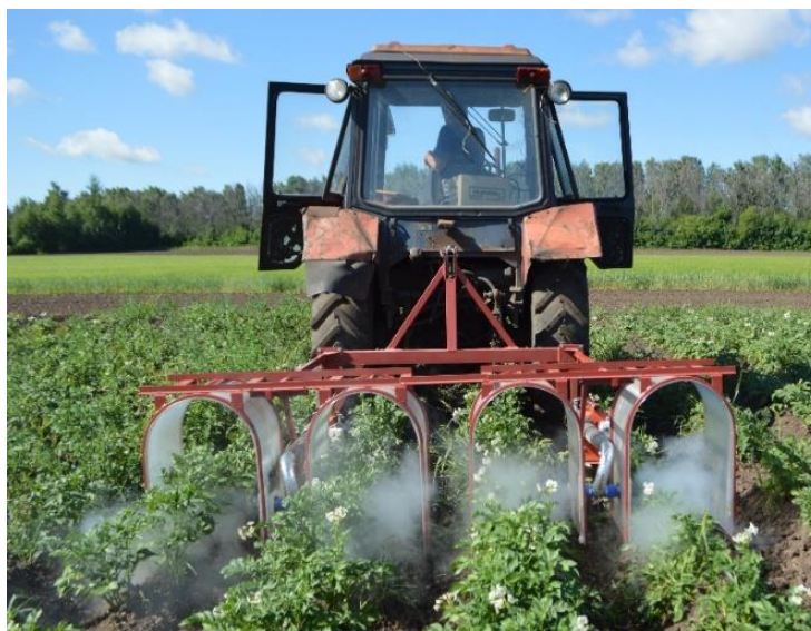
Рисунок 4.21 – Обработка посадок картофеля аэрозольным опрыскивателем пропашных культур
