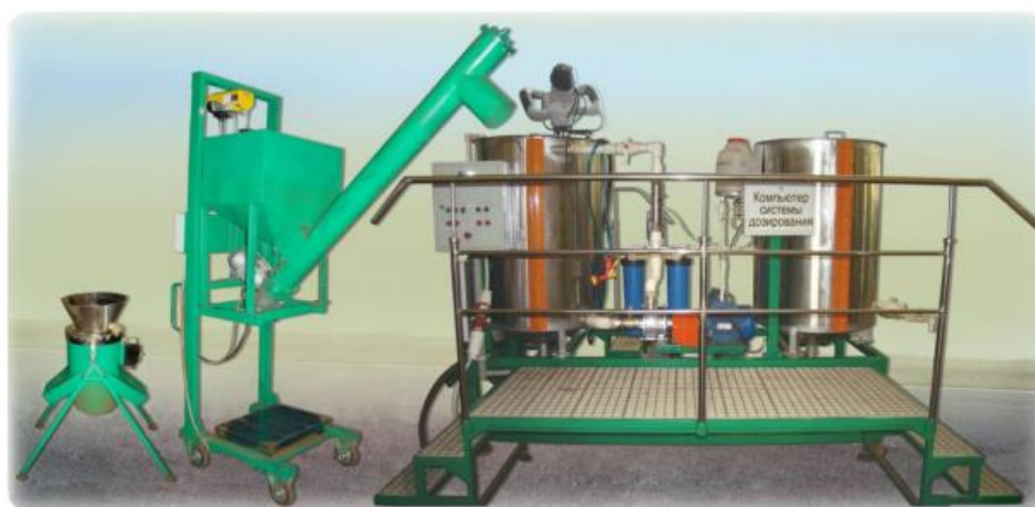
Рисунок 1.9 – Технологическая линия производства гуминовых удобрений из бурого угля [189, 190]
