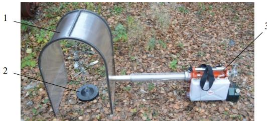
1 – макет тоннельного укрытия; 2 – лабораторный штатив; 3 – генератор горячего тумана
