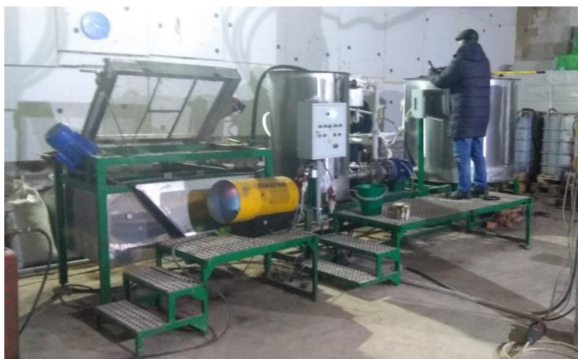
Рисунок 2.11 – Процесс получения партии органоминеральных удобрений из торфа для исследования качества работы системы очистки
