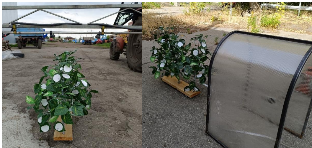
Рисунок 4.16 – Общий вид расположения имитации растений картофеля при обработке штанговый опрыскиватель ОП – 1000/18 и генератором горячего тумана марки BF-150 с макетом тоннельного укрытия
