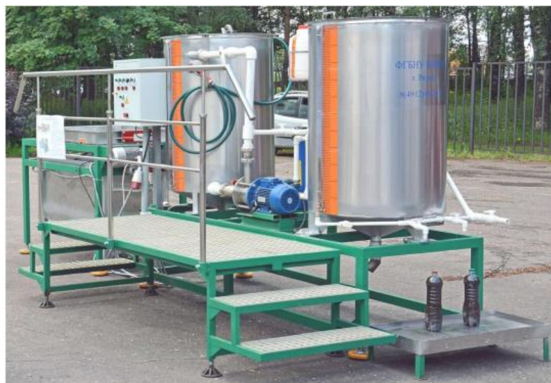
Рисунок 1.8 – Технологическая линия для производства гуминовых удобрений из торфа [189, 190]
