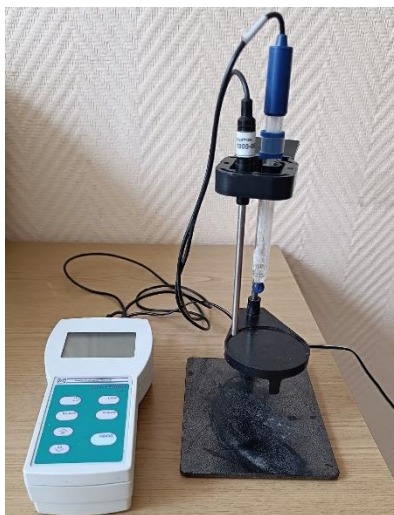
Рисунок 2.24 – Общий вид pH метра pH – 150 МИ
