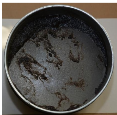
Рисунок 2.15 – Образец сита в процессе оценки балластного остатка в образцах органоминеральных удобрений
