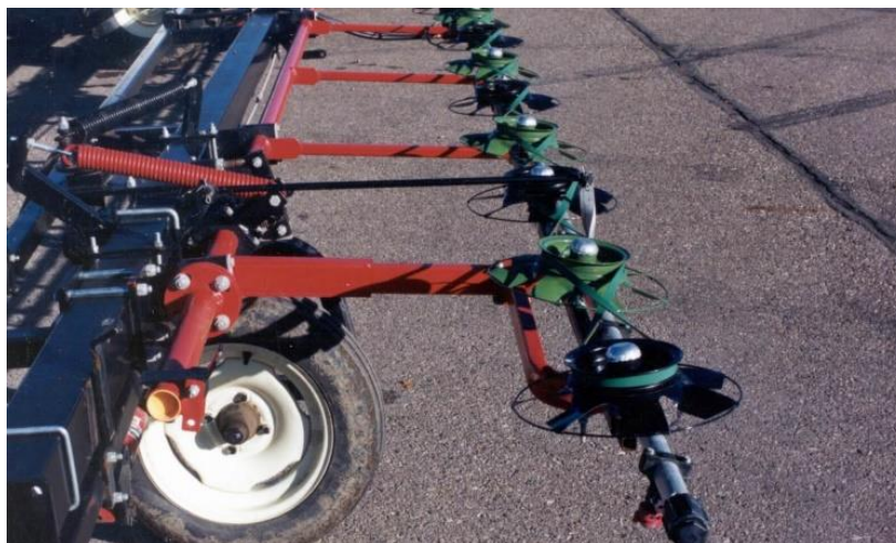
Рисунок 1.12 – Вентиляторный опрыскиватель Калетча
