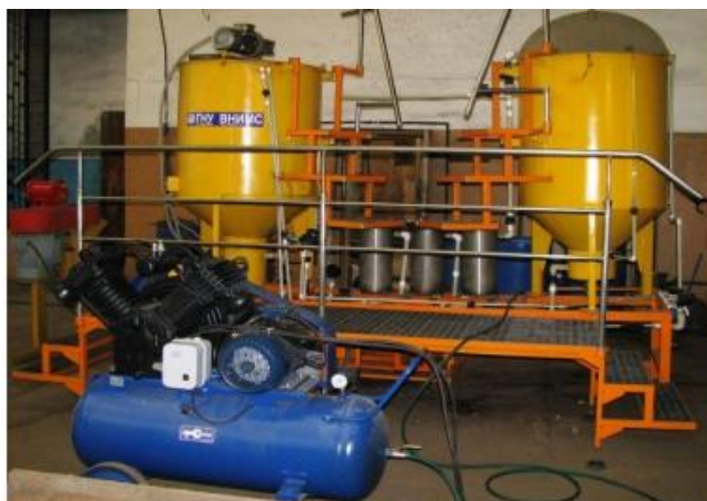
Рисунок 1.6 – Технологическая линия с системой ультразвукового диспергирования [189, 190]
