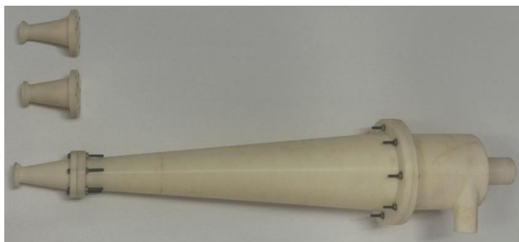
Рисунок 2.12 – общий вид циклона со сменными пусковыми насадками
