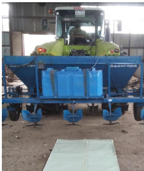
Рисунок 3.26 – Общий вид культиватора подкормщика-гребнеобразователя при исследовании равномерности распределения удобрений по площади
