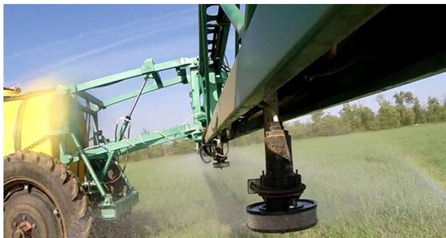
Рисунок 1.13 – Вращающийся электрический распылитель
