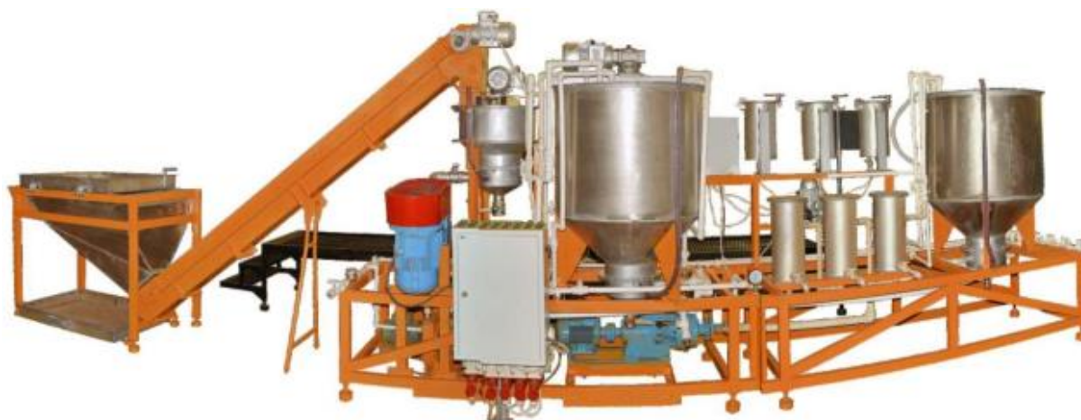
Рисунок 1.7 – Технологическая линия для производства комплексных удобрений на основе гуминовых образца 2014 года [189, 190]
