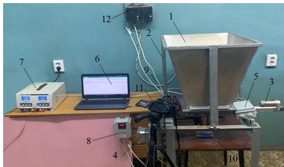
1 – бункер для минеральных удобрений; 2 – станина; 3 – актуатор марки ЛАЗ-24-28-25-200ДХ; 4 – мотор-редуктор NMRV 063-10-90-1,1-B3-FB; 5 – блок управления; 6 – ноутбук; 7 – лабораторный источник питания W.E.P. 3005D-11; 8 – частотный преобразователь ВЕСПЕР EI – 8001-002Н; 9 – тахометр UT372; 10 – лабораторные весы МН-500; 11 – камеры Nikon D5200; 12 – вводной автомат
