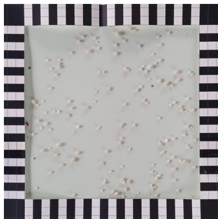
Рисунок 3.28 – Общий вид рамки с распределенными минеральными удобрениями
