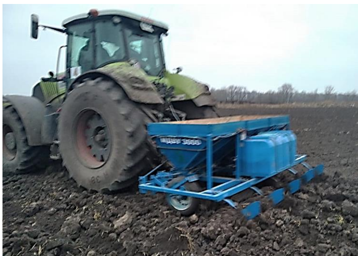
Рисунок 3.38 – Локально-ленточное внесение твердых минеральных удобрений и гумата калия при помощи гребнеобразующего культиватора-подкормщика
