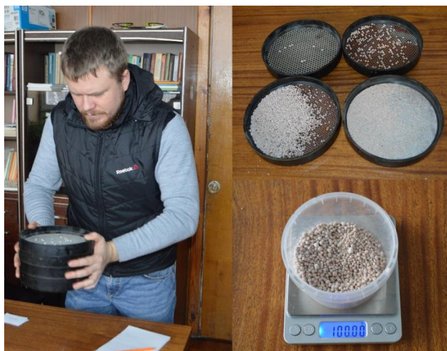
Рисунок 3.24 – Процесс определения гранулометрического состава удобрений
