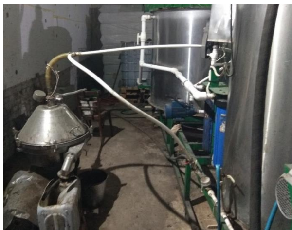
Рисунок 2.14 – Система чистки с применением центрифугирования
