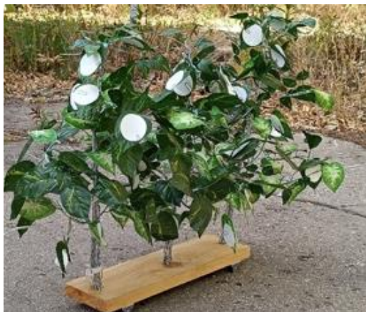
Рисунок 4.15 – Имитация растений картофеля с закреплёнными дисками фильтровальной бумаги
