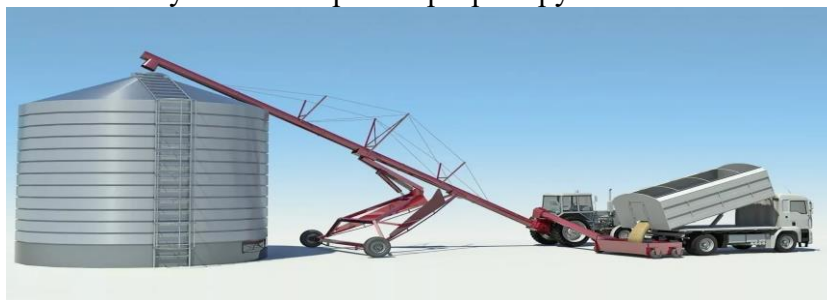
Рисунок 1.5 – Схема загрузки корма при силосовании в башнях
