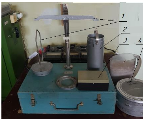
1 – весы пурки; 2 – мерный цилиндр; 3 – набор разновесов; 4 – решётный классификатор Рисунок 2.4 – Лабораторное оборудование для определения объемной плотности силосуемой массы
