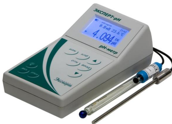
Рисунок 3.7 – рН-метр для растворов и жидкостей
