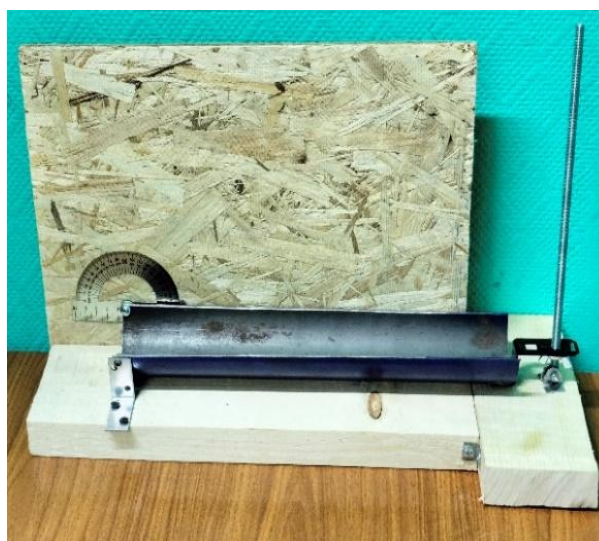
Рисунок 3.5 - Платформа для измерения угла скольжения семян.
