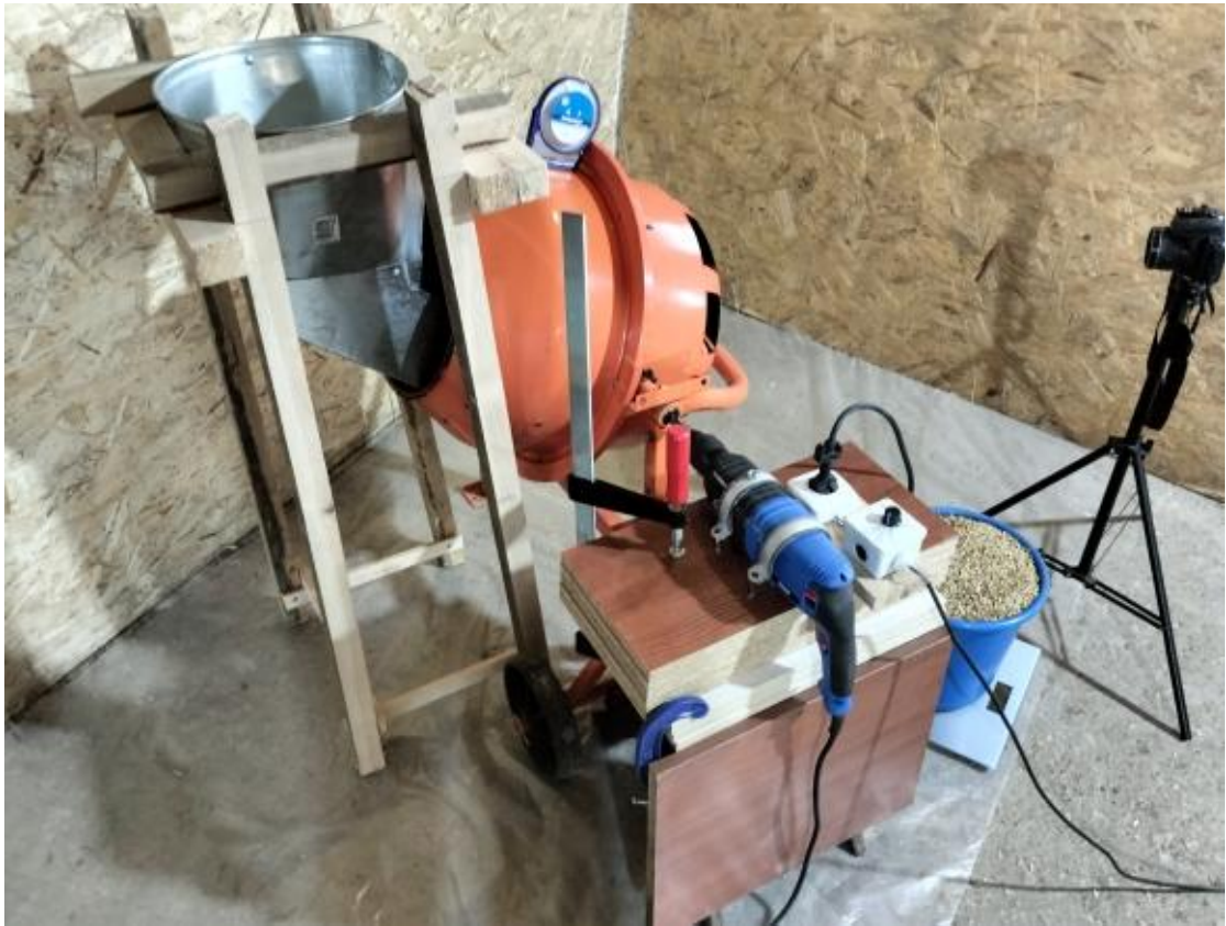
Рисунок 3.8 – Лабораторная установка для определения параметров производительности барабанного смесителя семян
