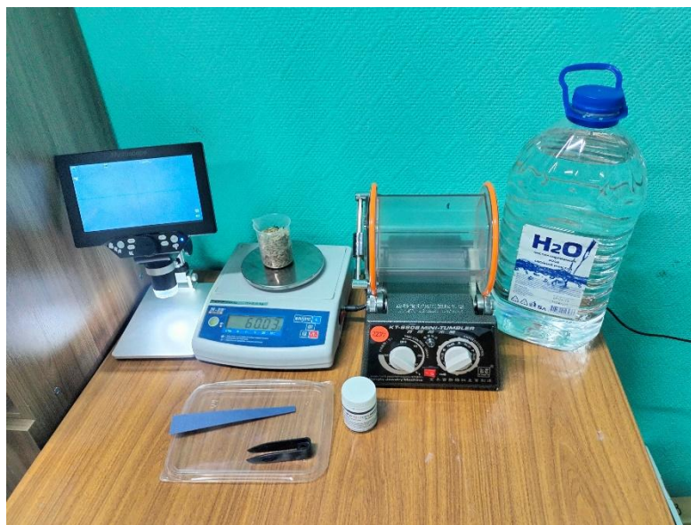
Рисунок 3.2 – Оборудование для оценки повреждения семян
