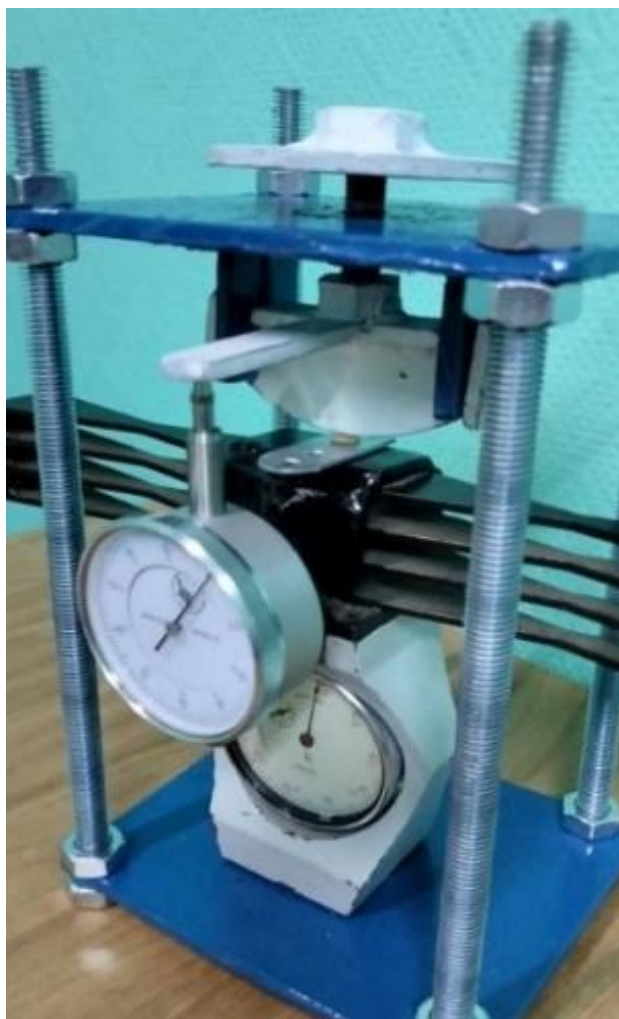
Рисунок 4.5 – Прибор для измерения механических характеристик семян
