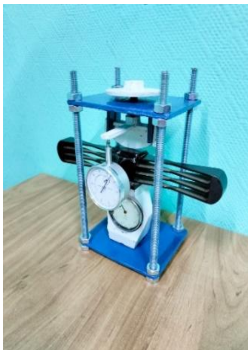
Рисунок 3.6 - Общий вид прибора для измерения деформации и прочности семян зерновых сельскохозяйственных культур
