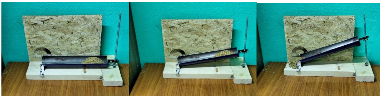
Рисунок 4.3 – Установка для изучения трения семян
