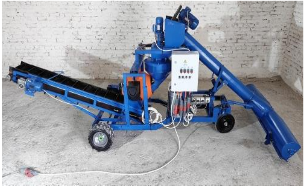
Рисунок 4.28 – Опытный образец протравливателя семян с барабанным смесителем
