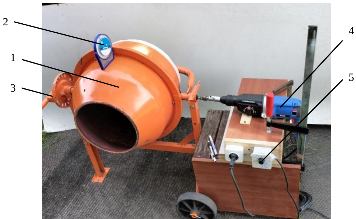
1 –барабан; 2 – прибор для измерения угла наклона барабана; 3 – механизм для измерения угла наклона; 4 – электрический привод барабана; 5 – регулятор частоты вращения
