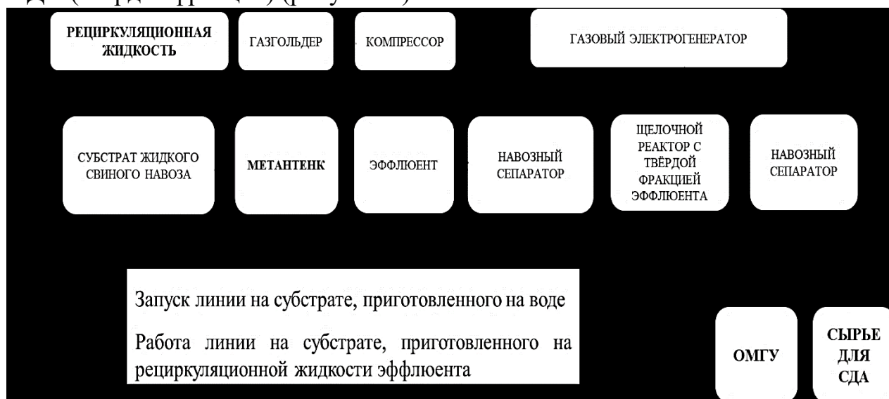
Рисунок 1 – Блок-схема предлагаемого способа утилизации свиного навоза (ОМГУ – органоминеральное гуминовое удобрение, СДА – структурирующая добавка для асфальтобетона).
