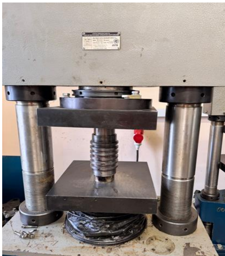
Рисунок 4.8 – Формование лабораторных образцов асфальтобетона
