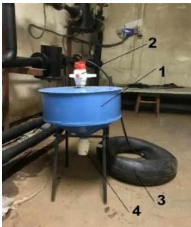
Рисунок 3.1 – Лабораторная биогазовая установка, работающая в психрофильном режиме:
