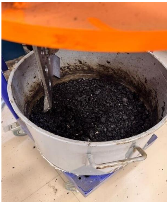
Рисунок 4.7 – Процесс приготовления асфальтобетонной смеси
