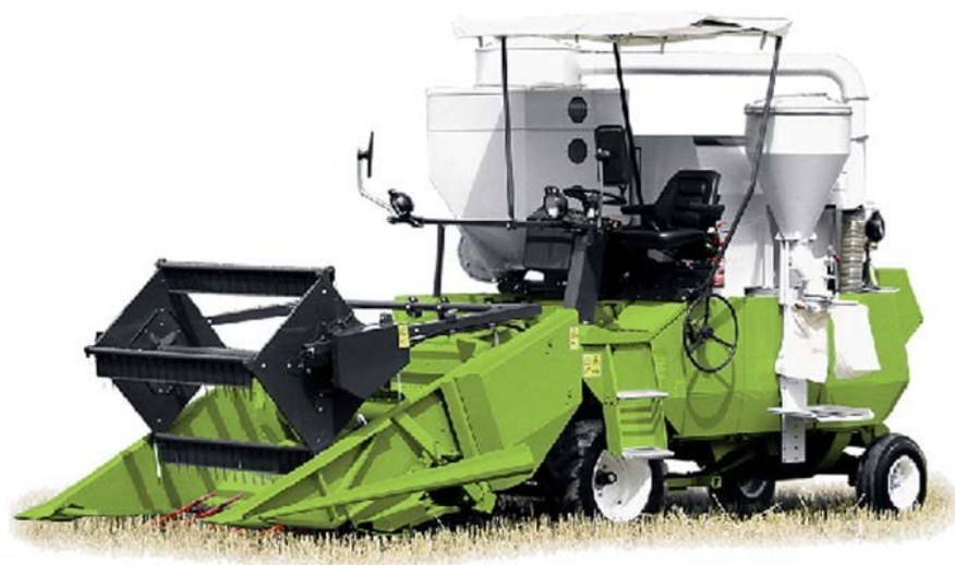
П.А.Р.8- Малогабаритный селекционный комбайн«Classic» Wintersteigen-ВИМ
