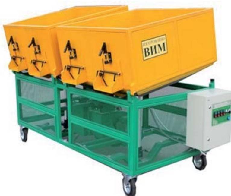
П.А.Р.10 -Сушилка лотковая селекционная СЛ-0,3u2
