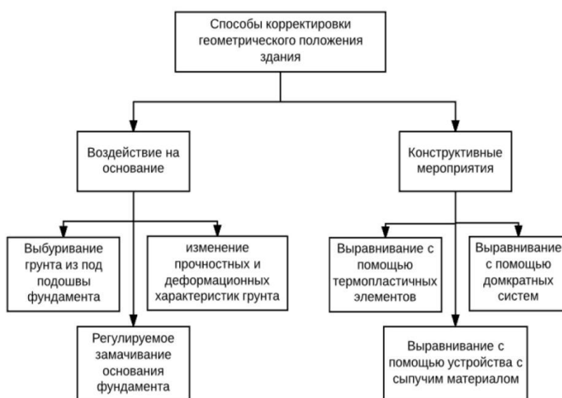
Рисунок 1 – Способы корректировки геометрического положения здания
