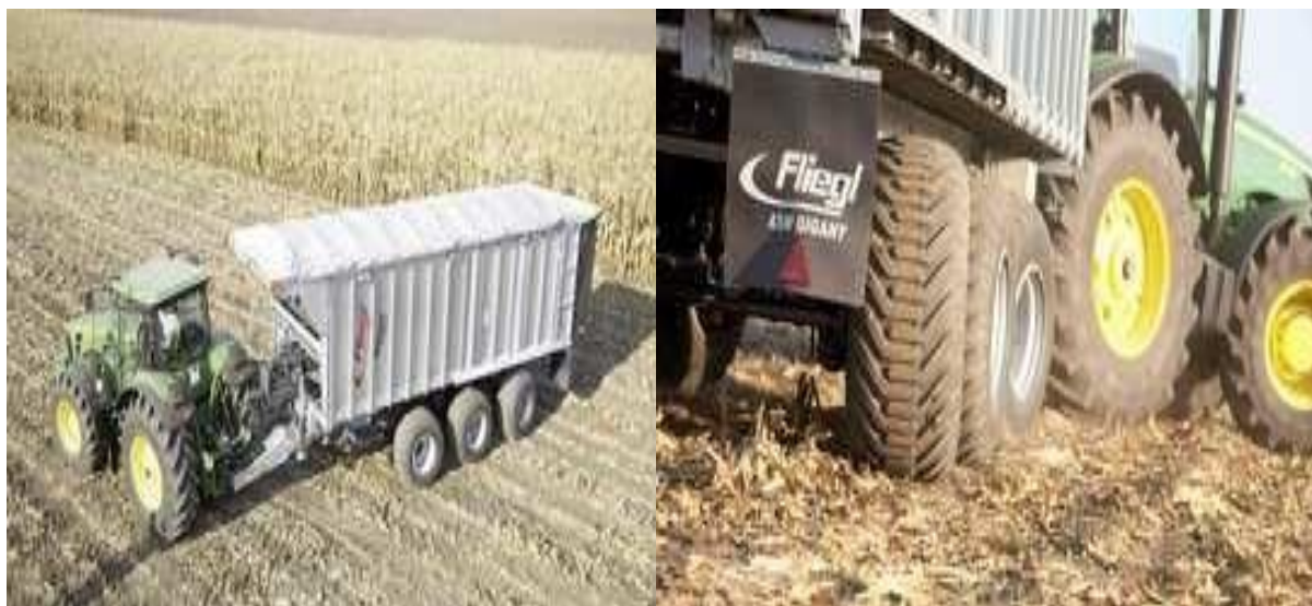
Рисунок 3 – Тракторный поезд с системой электронного принудительного подруливания „ForCon“
