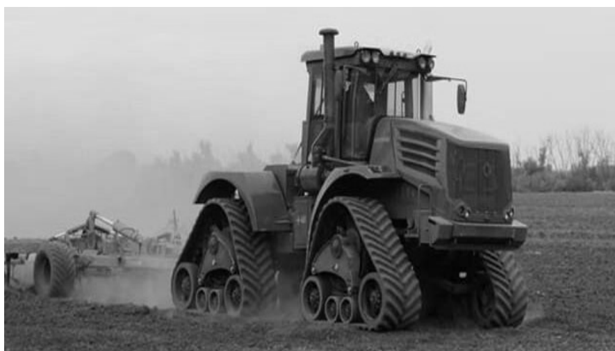
Рисунок 3 – «Четырехгусеничная» модификация трактора К-744 [5]
