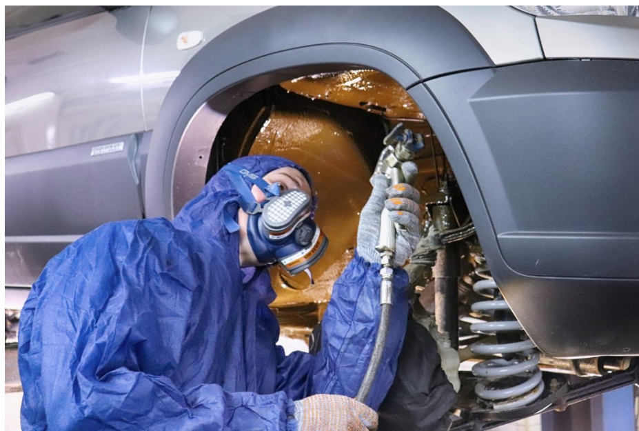
Рисунок — 7 Нанесение консервационного состава на окрашенные полости кузова, наиболее подверженные возникновению очагов коррозии
