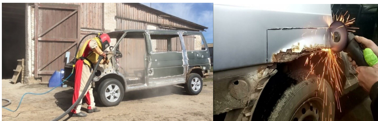
Рисунок 5 — Пескоструйная обработка кузова (слева) и механическое удаление пораженного коррозией участка режущим инструментом (справа)
