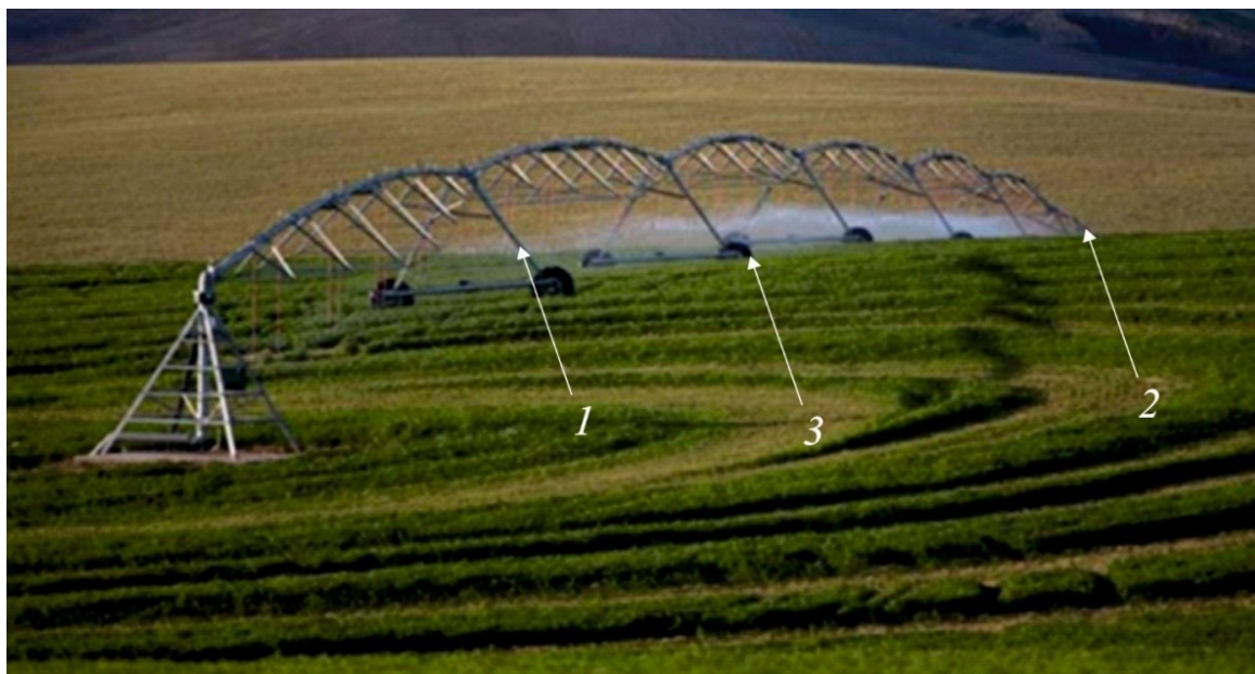
1 – опорная тележка; 2 – консольная часть; 3 – пневматическое колесо Рисунок 1 – Общий вид дождевальной машины «Кубань-ЛК1»
