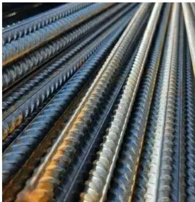
Рисунок 4 – Серповидный профиль арматуры
