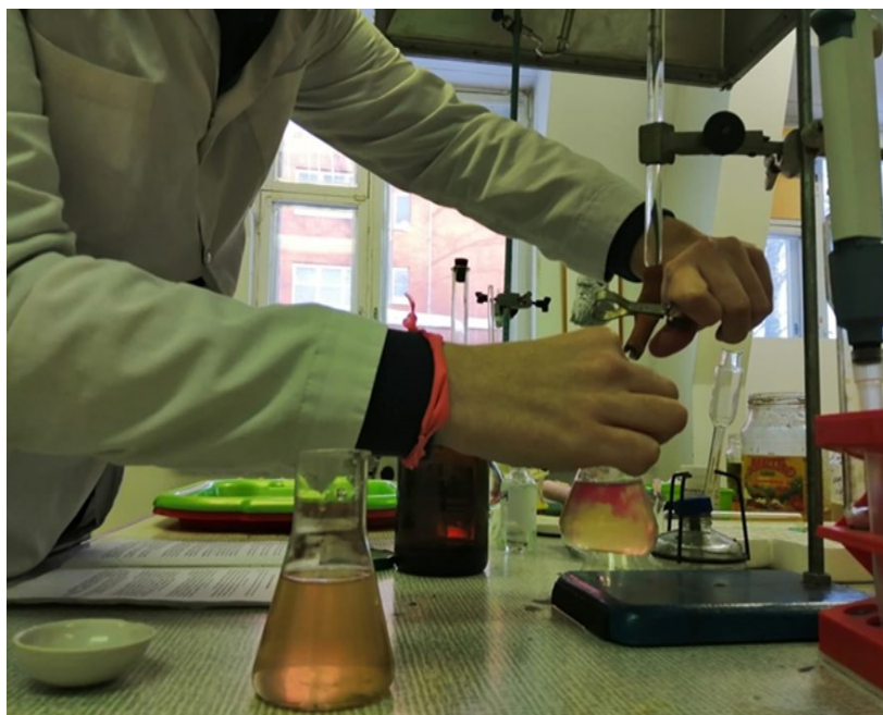
Рисунок 2 – Метод титрования на присутствие поваренной соли
