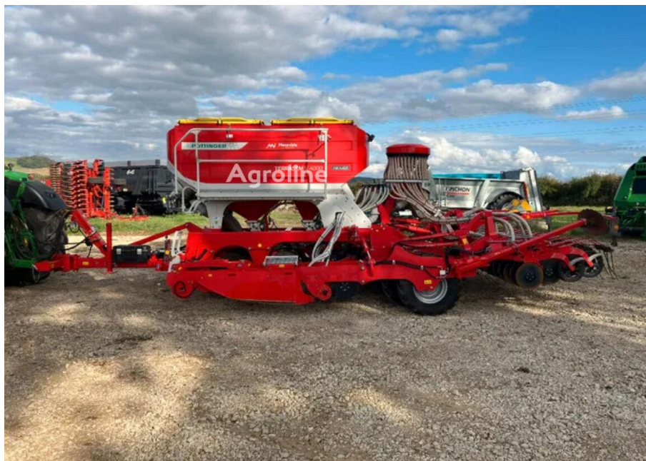
Рисунок 1 – Посевной комплекс TERRASEM 4000D
