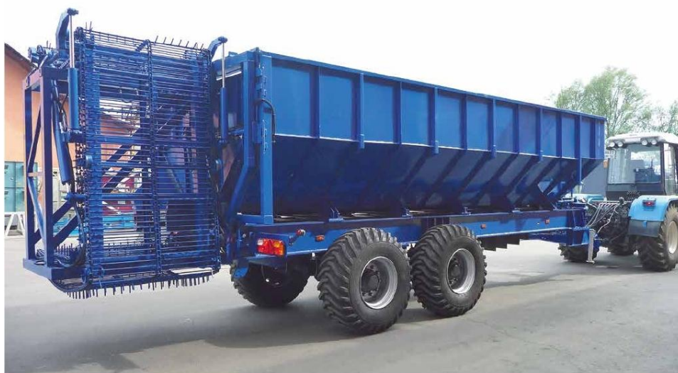
Рисунок 1 – Картофелевоз с системой мягкой разгрузки
