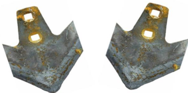
Рисунок 2 – Характерные дефекты культиваторных лап в результате износа
